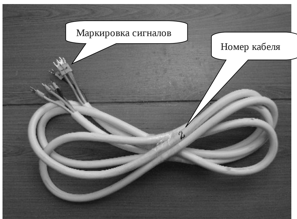
Рисунок 11 Пример маркировки кабеля.
